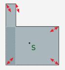
Liegt der Schwerpunkt in einem Schenkel und ist der kürzere Schenkel länger als 3 Meter, oder beträgt der Abstand zwischen dem Schwerpunkt und der davon am weitesten entfernten Ecke mehr als 3 Meter, kann die Anordnung einer Bewegungsfuge erforderlich sein.
