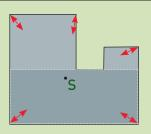
Liegt der Schwerpunkt in einem Seitenfeld der Basis und ist der gegenüberliegende Schenkel länger als 3 Meter, kann die Anordnung einer Fuge erforderlich sein.
