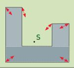
Liegt der Schwerpunkt außerhalb der Fläche, so ist die Anordnung einer Fuge sinnvoll.
