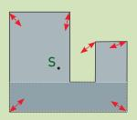
Liegt der Schwerpunkt innerhalb eines Schenkels, so ist die Anordnung einer Fuge sinnvoll.
